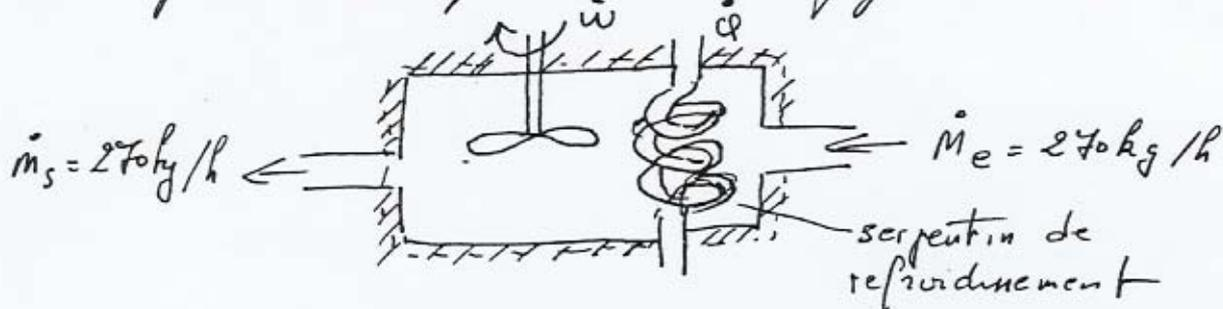
On écrit les bilans masse et énergie pour le système ouvert (délimité par des pointillés). Soient  $M, U, T$  les masse, énergie interne et température du système :
