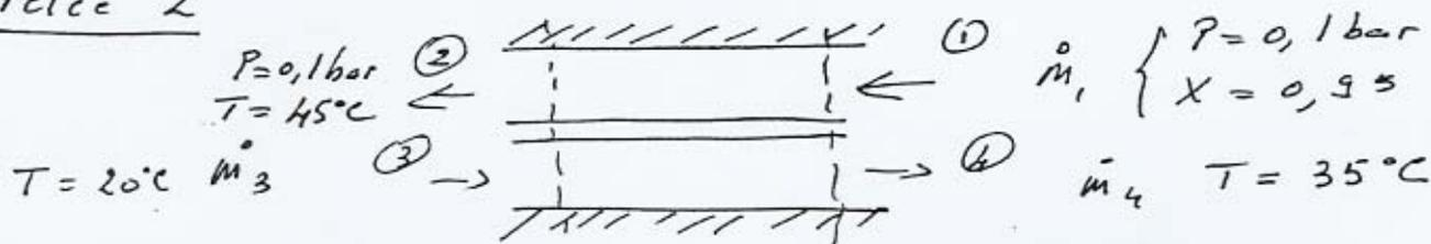
① A l'aide de la table fournie des valeurs de grandeurs thermodynamiques à l'état de saturation (équilibre liquide-vapeur) pour l'eau, on trouve la température d'entrée du mélange liq. vap dans l'échangeur
